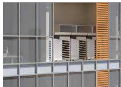
La unidad exterior está oculta dentro del edificio sin afectar a la imagen general del edificio
